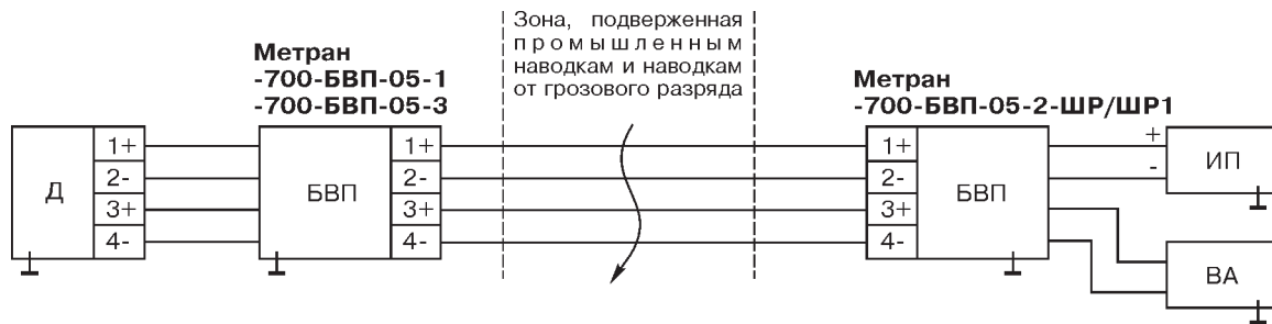
Рис.3. Защита датчика обыкновенного исполнения, ИП и ВА при 4-х-проводной линии связи с помощью 2-х барьеров.
